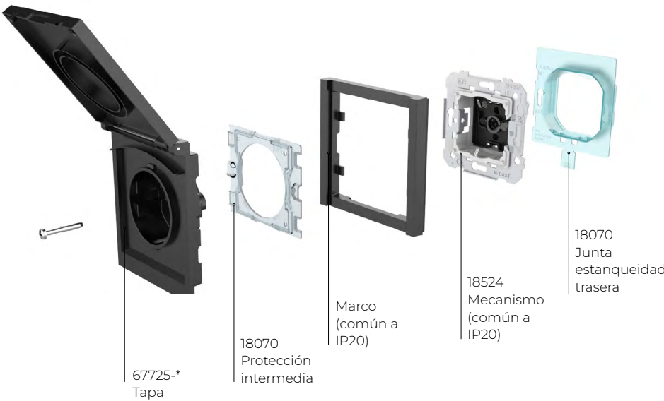
Explosionado Cosmos Schuko® IP44:
