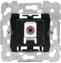
Toma mono RCA 18575 Emborne trasero rápido por perforación de aislante. Cable: máximo 3 pares de 0,3 mm 2
