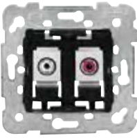
Toma estéreo RCA 18576 Emborne trasero rápido por perforación de aislante. Cable: máximo 3 pares de 0,3 mm 2
