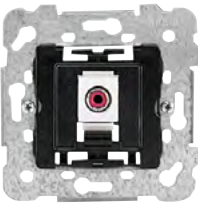
Toma mono RCA 18575 Emborne trasero rápido por perforación de aislante. Cable: máximo 3 pares de 0,3 mm²
