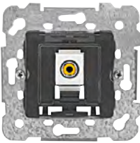
Toma vídeo RCA 18577 Emborne trasero rápido por perforación de aislante. Cable: máximo 3 pares de 0,3 mm²
