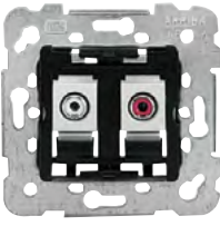
Toma estéreo RCA 18576 Emborne trasero rápido por perforación de aislante. Cable: máximo 3 pares de 0,3 mm²
