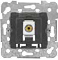
Toma vídeo RCA 18577 Emborne trasero rápido por perforación de aislante. Cable: máximo 3 pares de 0,3 mm²
