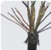
**3.** Elimine unos 10mm de la lámina de blindaje de los cables de señal. Retire aproximadamente 5mm de la camisa de cada uno de los cables y estañe las puntas con un soldador. (alternativa: usar terminales para cable de 0,34mm).
