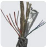
**1.** Retirar aproximadamente 45 mm de la camisa exterior del cable. Retirar la malla exterior para dejar los cables a la vista y corte el sobrante de la malla exterior.
