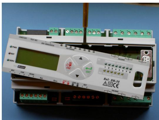
3. Fíjese en el conjunto de miniinterruptores situado en el ángulo superior izquierdo y que está marcado en la placa del circuito como SW2.
