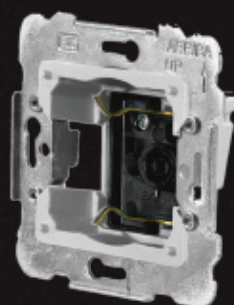
Mecanismo con bastidor de zamak para resistir un fuerte atornillado que permite que la membrana de EPDM quede oculta en el marco.
