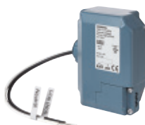
Fuente de alimentación tipo JB de 80 mA 5WG1125-4CB23 Tipo: JB 125C23 Para montaje en el interior o anexas a cajas de conexión tipo UL/NEMA mediante conector roscado de 1/2". Tensión de alimentación de 120 V CA 50..60 Hz.
