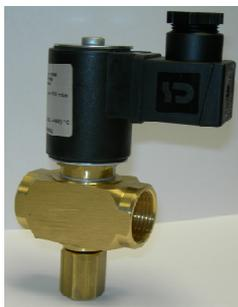
El 25234 es una electroválvula de gas cuya función es dotar de mayor seguridad a la instalación en caso de una alarma de gas mediante el corte de suministro del mismo. Puede ser accionada por un detector de gas directamente o por un equipo domótico..
