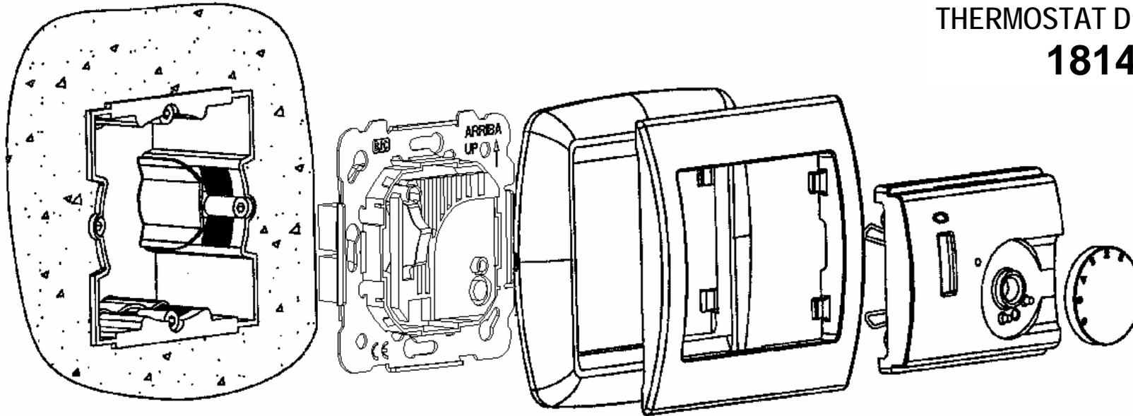
Termostato para regulación de temperatura en interiores para control de convectoros eléctricos y de agua caliente, bombas y calderas.
