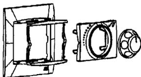
Para desmontar hacer palanca con un destornillador en el punto indicado, para extraer la placa y la tapa. Posteriormente sacar el botón con la mano.
